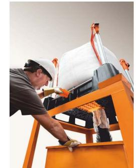
Manuelle Entleerung mit Dosier- und Arretiermöglichkeit.
